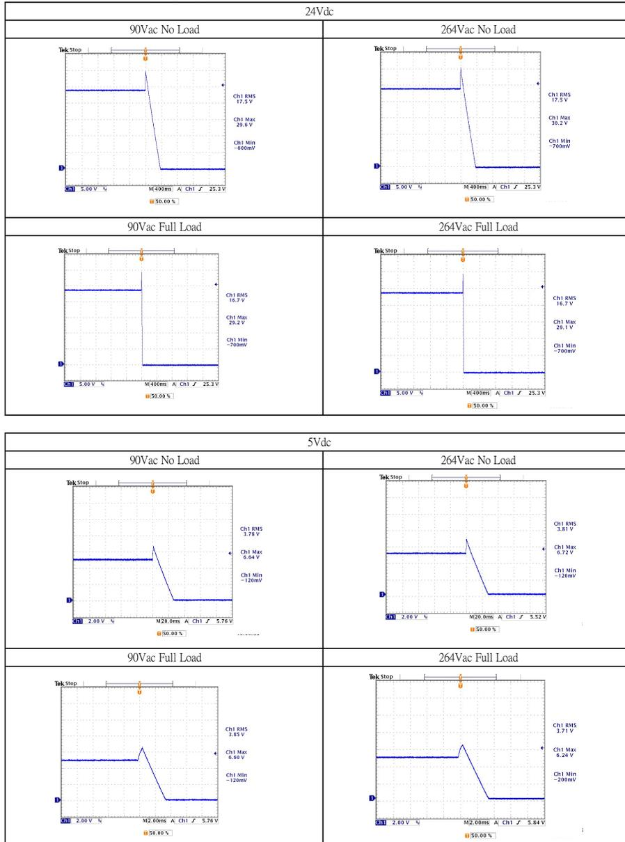
1-4.Over-Current Protection(過電流保護特性)
