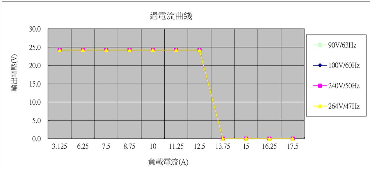
1-4.Over-Current Protection(過電流保護特性)
